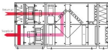
**Ночной режим с нагревом.** DanX работает в режиме рециркуляции без подачи свежего воздуха. Воздух из бассейна рециркулируется и нагревается на водяном нагревателе. Термический насос остановлен. Вентиляторы работают на низкой скорости.
