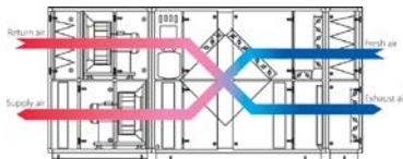
**Дневной режим в летнее время.** DanX работает в режиме 100% подачи свежего воздуха. Водяной нагреватель и термический насос остановлены, поскольку температура приточного воздуха после рекуператора достаточно высока. Вентиляторы работают на нормальной скорости. Осушение происходит за счет ассимиляции влаги свежим воздухом.
