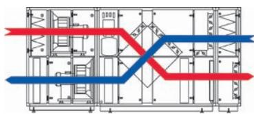
**Дневной режим в летнее время, фрикулинг.** DanX работает в режиме 100% подачи свежего воздуха. Для поддержания заданной температуры в помещении и исключения перегрева, автоматически часть воздуха проходит мимо рекуператора через байпас - при наружном воздухе немного прохладнее заданной температуры. Вентиляторы работают на нормальной скорости. Осушение происходит за счет ассимиляции влаги свежим воздухом.
