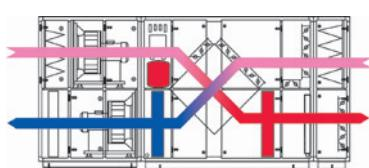
**Дневной режим с активным охлаждением (только XWPRS).** DanX работает в режиме 100% подачи свежего воздуха. Байпас закрыт, наружный воздух предварительно охлаждается в рекуператоре - при температуре наружного воздуха выше заданной. Приточный воздух охлаждается на испарителе. Вентиляторы работают на нормальной скорости. Осушение происходит за счет ассимиляции влаги свежим воздухом и частично при охлаждении на испарителе.
