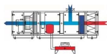
**Ночной режим с подогревом воздуха.** Установка работает в режиме рециркуляции без подмеса свежего воздуха, при этом воздух из помещения бассейна подогревается на водяном или электрическом нагревателе. Вентилятор работает на пониженной скорости.
