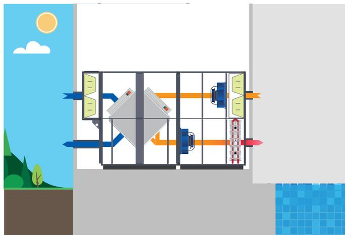
Может потребоваться частичная рециркуляция воздуха: от 0 до 100% его объема, в зависимости от требований на объекте. В смесительной камере осушителя воздушные потоки смешиваются.
